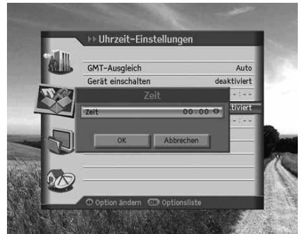
**Hinweis:** Wenn Sie die Ein-/Abschaltautomatik aktiviert haben, wird das Gerät jeden Tag zur angegebenen Uhrzeit wiederholt ein- und ausgeschaltet.
