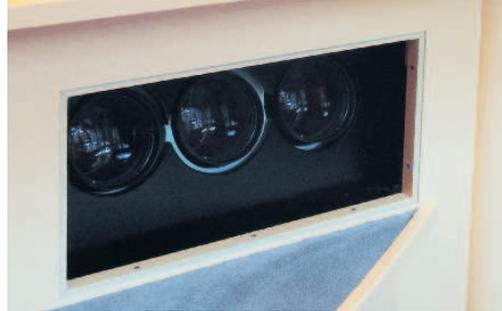
Hinter einer entspiegelten Spezialscheibe isoliert, verrichtet der Seleco absolut geräuschfrei seine Arbeit. Die rund 2 m³ Luft im Inneren des schalldichten Podests reichen für die Kühlung der Projektor-Röhren völlig aus.
